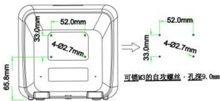
图 2-4 挂墙孔安装尺寸
