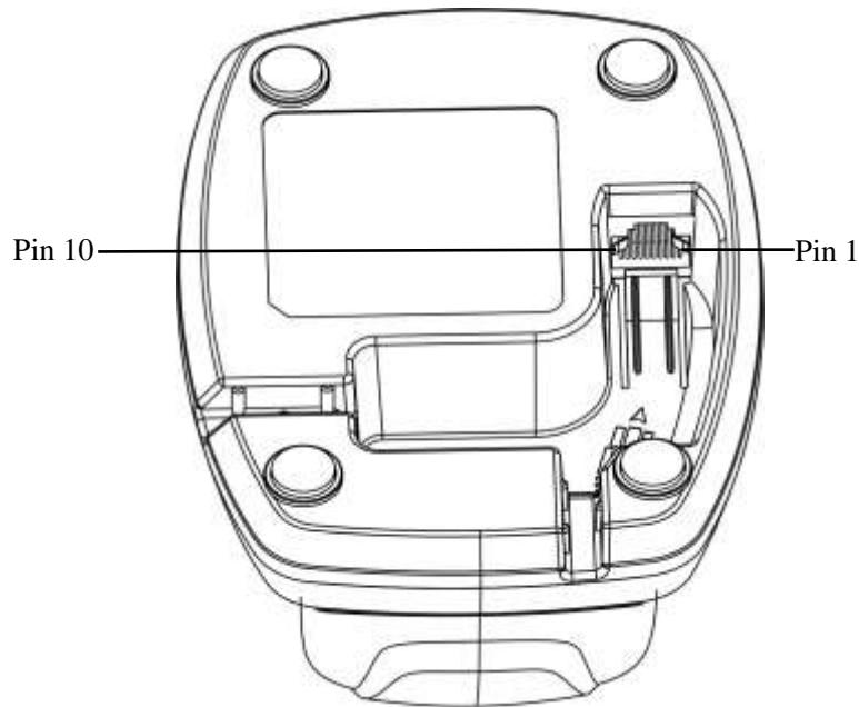
图 2-1 基座线缆连接头引脚示意图
